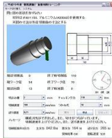
図 2. 旋盤トレーニング実行画面 (シミュレータ)
