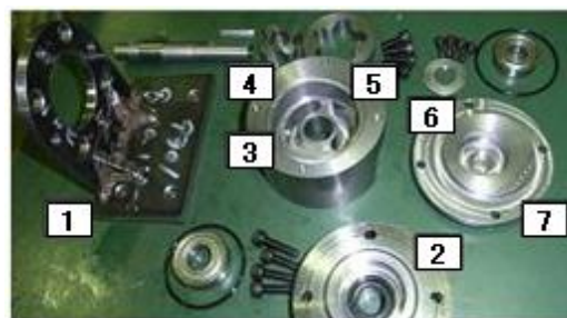
図7 製作した主要部品と市販の標準部品
