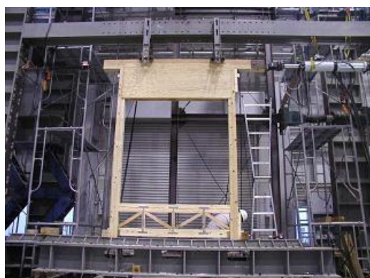
写真1 垂れ壁足固め補強タイプの実験風景
