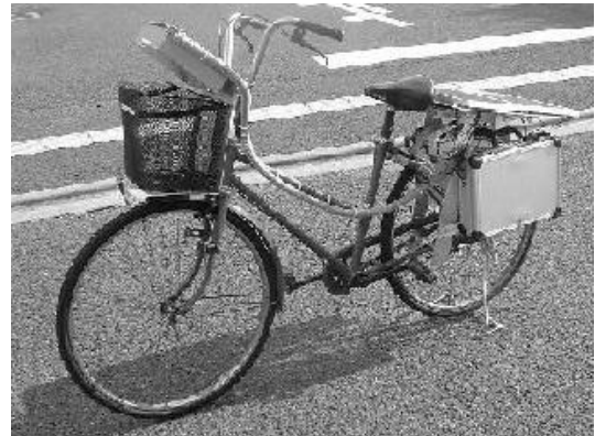
図2 自転車発電機概観
