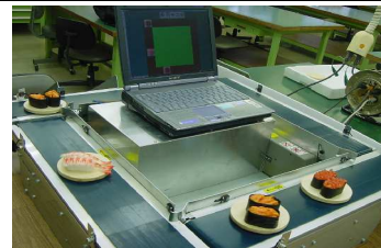
< 図2 制作した回転寿司システム >
