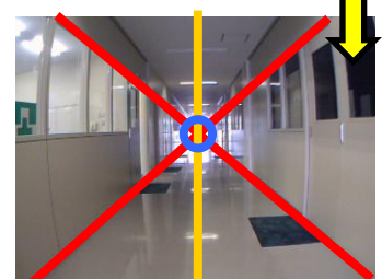
図5 画像認識による進行方向の決定
