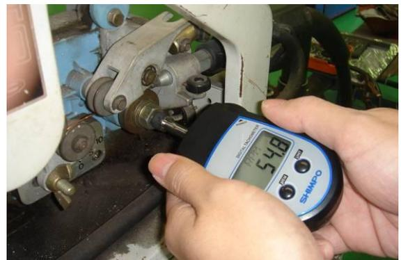
図2 ワイヤ溶融速度の計測
