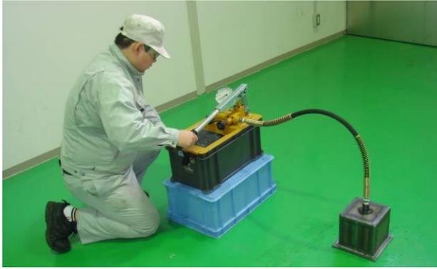
図 6 耐圧試験の実施状況
