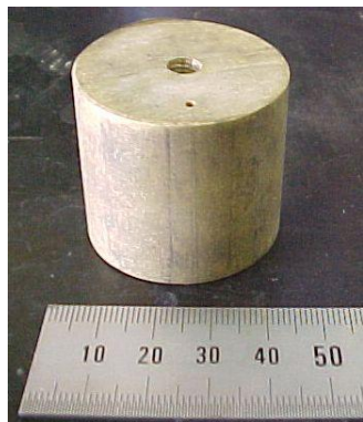
写真3 加熱後の供試円柱 (黄銅)
