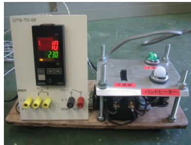
図2 温度制御装置
