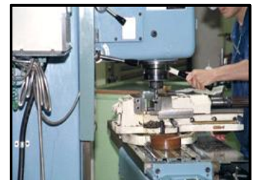
図1 フライス盤作業
