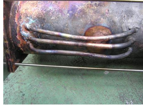
図2 製作した水管部分
