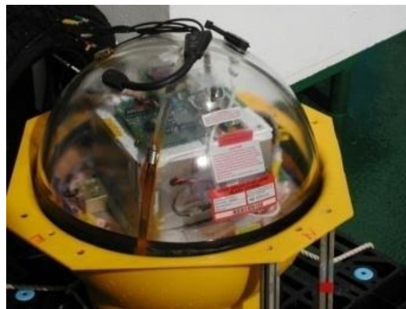
図 4 開発した機器 KPC-OBE の外観 (左図) とガラス球耐圧容器 (右図)
