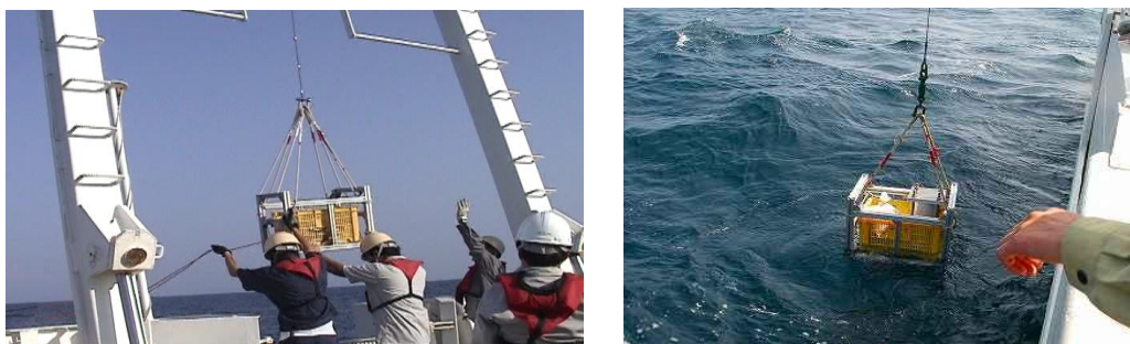
図7 アルミ製耐圧容器の耐圧・耐水性実験風景
