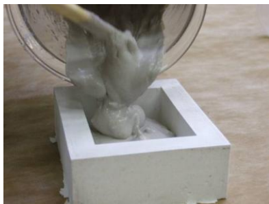
図 8 石膏の流し込み風景
