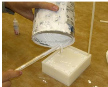
図 6 シリコン材の 流し込み風景
