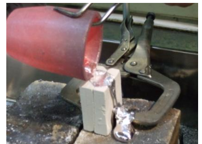
図 10 アルミ材の注湯風景
