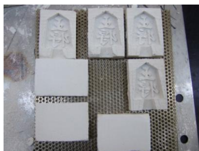
図 9 完成した石膏型
