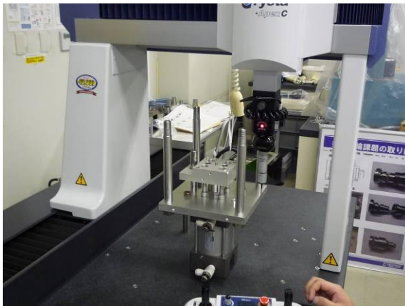
図4 組立て精度の測定
