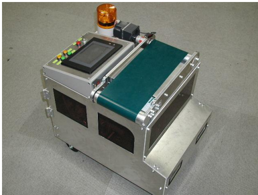
写真1 完成した AGV
