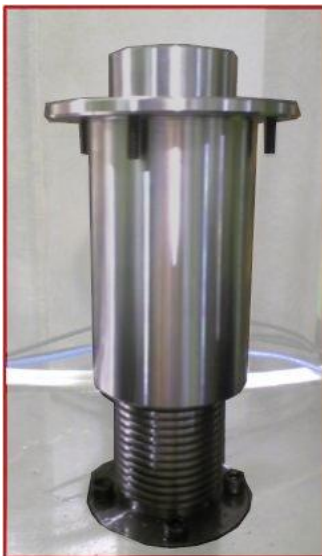
NC旋盤で角ねじ加工した Z軸送り機能
