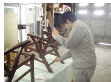
写真3 塗装作業と素地調整
