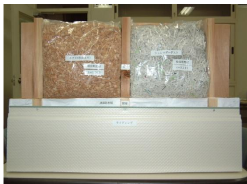
図1 リサイクル吸音・断熱材 (左：秋田スギ木くず、右：シュレッダーダスト)
