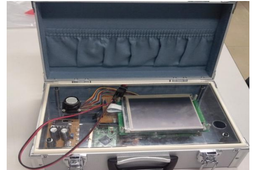
図5 コントローラ試作 中にパルスカウンタ回路、充電機能付き電源回路を装備し、バッテリーを取り外すことなく充電できるようにしました
