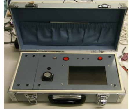
図3 計測コントローラ タッチパネルを使用することでキーボードレスを実現
