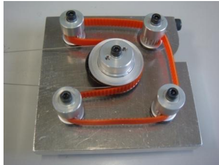
図4 ワイヤ送り出し機構実験装置 ワイヤ式エンコーダのワイヤ切れの際巻き込まないようにする機構
