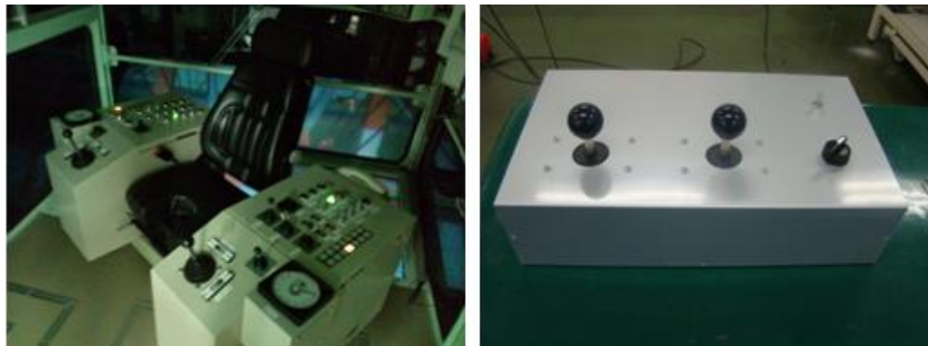
図3 コンテナクレーンシミュレータ運転室と模型用コントローラ
