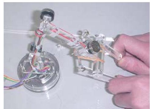
図 4 製作したマスター側コントローラ
