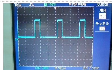
図4 PWM信号 (Duty比 25%)
