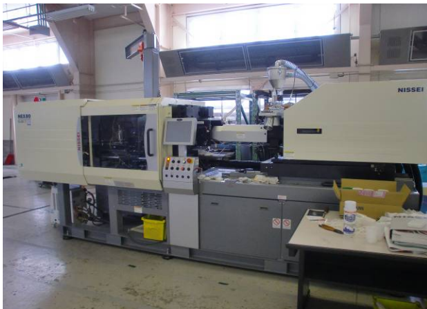
図6 射出成形と成形モニタ
