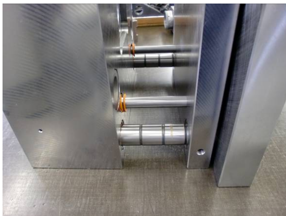
図7 分解した金型
