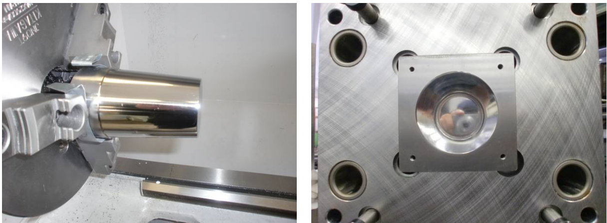
図5 コア (左側) とキャビティ (右側) の加工
