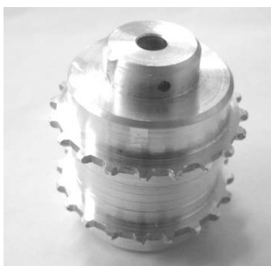
図2 クローラの駆動輪
