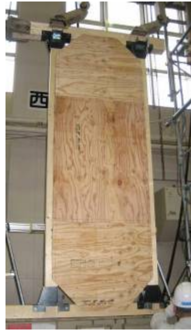
図9 耐力壁の面内せん断実験
