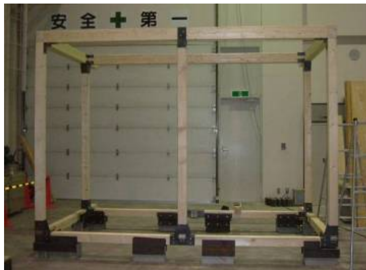
図7 専用接合部金物による木質軸組の完成
