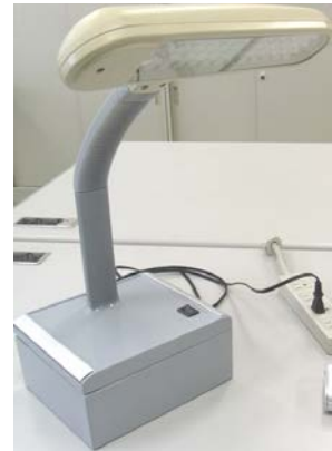
図1 製作したLED照明通信スタンド
