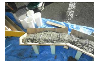
写真3 傾斜打設試験
