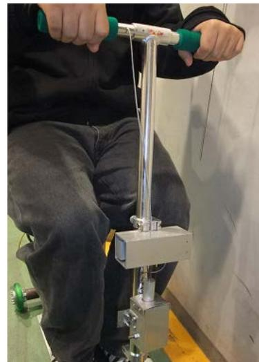
図2 アクセルの機構
