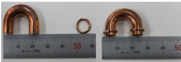
図1 組付け前のU字管とOリング（左）と完成品（右）
