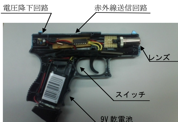
図 7. 赤外線光線銃の内部構造
