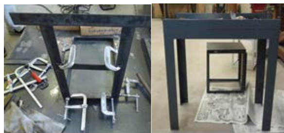
図 3 溶接前の固定
