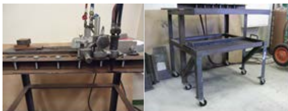
図 1 取り付け部改良 図 2 前足取り付け後
