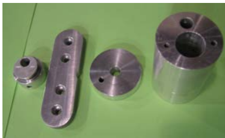
図 3 アルミで製作したシリンダ、フライホイール、偏心輪
