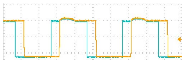
位相が早い波形：電圧波形 V_r (2V/DIV, 5ms/DIV)
