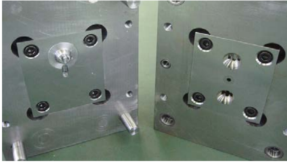
写真5 組立完了した胴体カセット式金型
