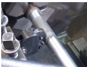
(写真4)ローレットで握り部を加工
