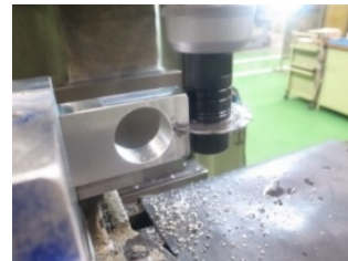
(写真2) 平フライスを使った溝切加工
