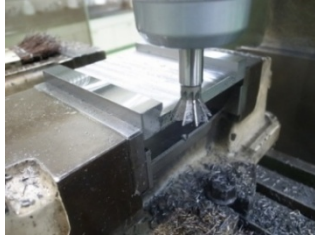
(写真3)アリ溝加工
