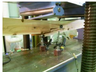
写真2 万能試験機による曲げ試験(試験体①)
