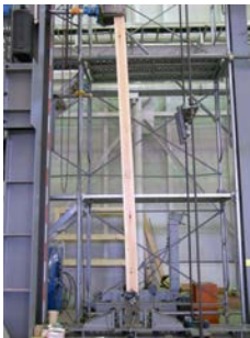
写真1 静的加力による曲げ試験
