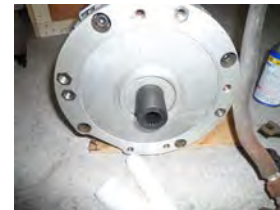
図 7. スプライン軸接続後
