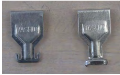
図9 クリップの破壊形状 (左：実験前，右：実験後)
