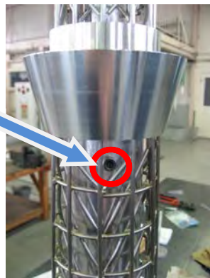
図9 パイプと展望台の固定部
