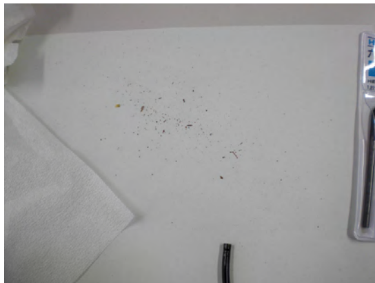
図17. 劣化セルから出てきた粉塵
