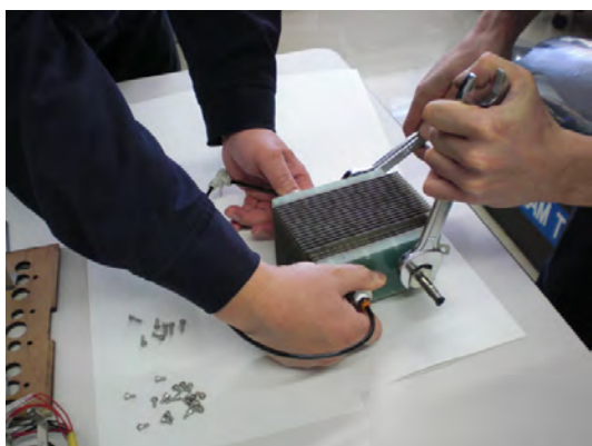
図16. 劣化セル除去作業風景
