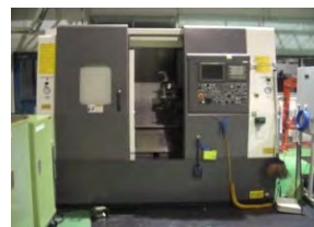
図3 ターニングセンタ (中村留精密工業株式会社製 SC-250)
