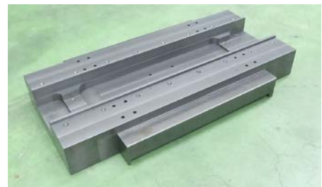
図 7. 往復台のガイド、ボールネジ取り付け部
