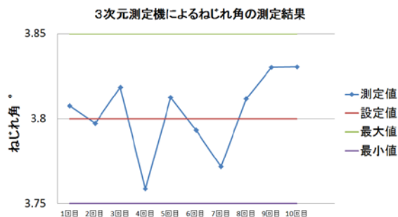
図8 3次元測定機による測定
