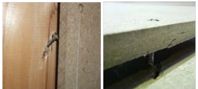
図7 破壊性状 (パンチングアウト左 MDF せん断破壊右)
