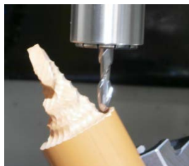
写真3 工具の突き出し量 (5軸加工)
