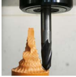
写真2 工具の突き出し量 (3軸加工)
