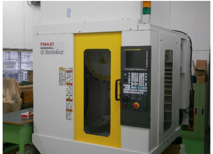
写真 1 5 軸加工機 (FANUC ROBODRILL)
