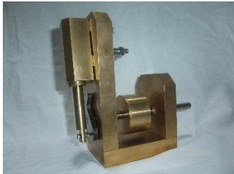
図1 完成したオシレーティングエンジン
