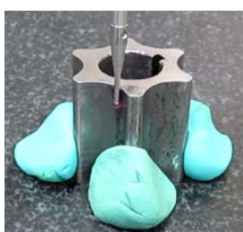
図1 3次元測定機による歯車の倣い測
