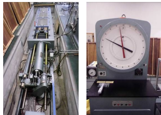
図2 引張試験機 (左: 引張装置 右: 制御装置)
