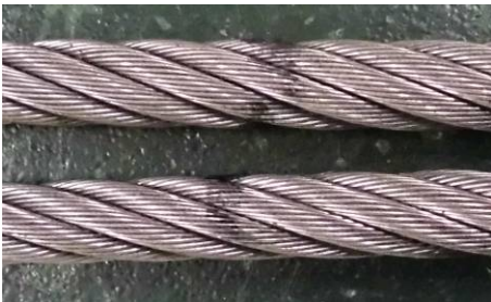
図5 新品と直径の減少が7%のワイヤーロープ ワイヤーロープの個体差
