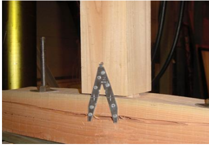
<図1 山形プレートの破壊形状>
