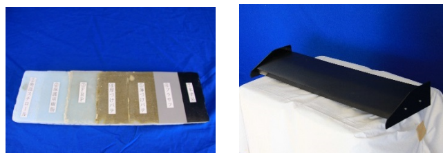
a. ウイング積層構造 b. 製作したウイング
